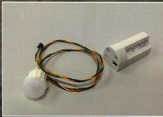
Een node van Mymesh wordt aan een lichtarmatuur gekoppeld voor voeding.
